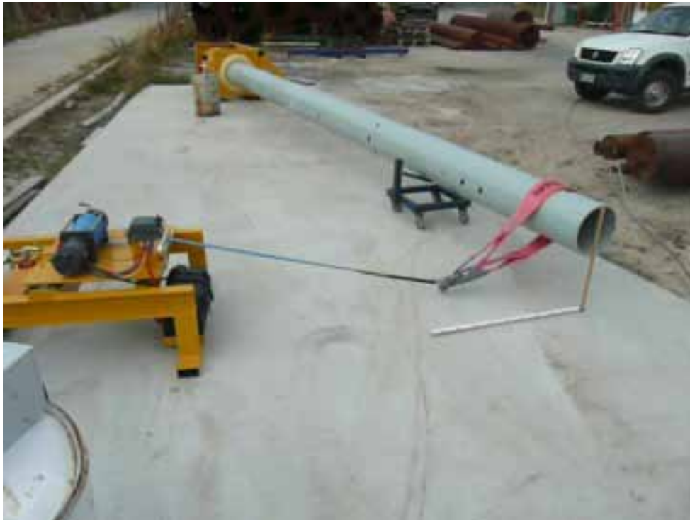
Fig 1. Pole Test Rig
